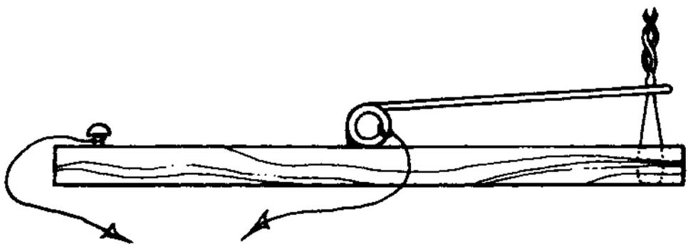
FIG. 70 MOUSETRAP SOLDER DELAY
