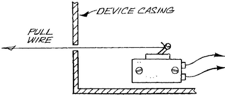
FIG. 13 TOGGLE SWITCH & PULLWIRE
