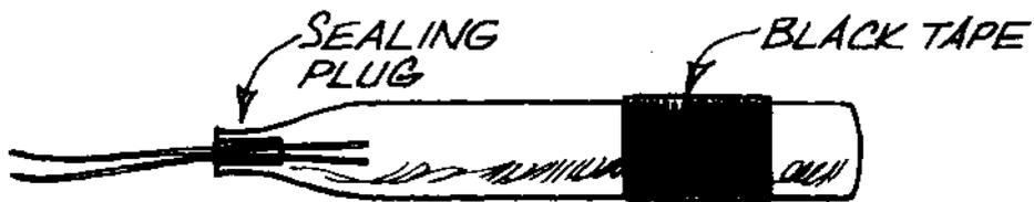
FIG. 101 IGNITOR S.F. ELECTRIC
