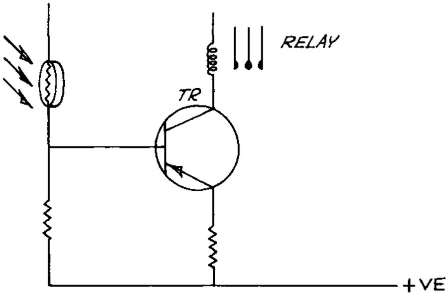
FIG. 81 LIGHT-SENSITIVE SWITCH
