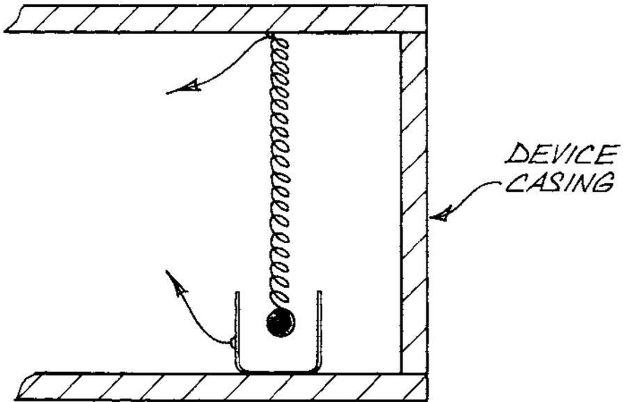
FIG. 48 PENDULUM SWITCH
