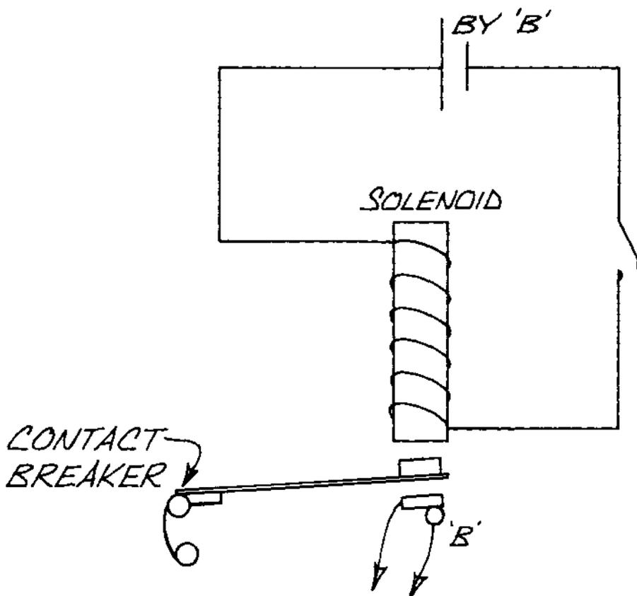
FIG. 53 SOLENOID & CONTACT BREAKER
