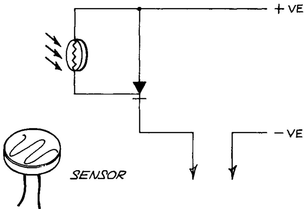
FIG. 80 LIGHT-SENSITIVE SWITCH
