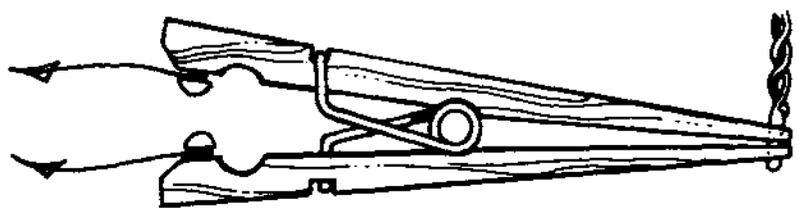
FIG. 68 C'PEG SOLDER DELAY
