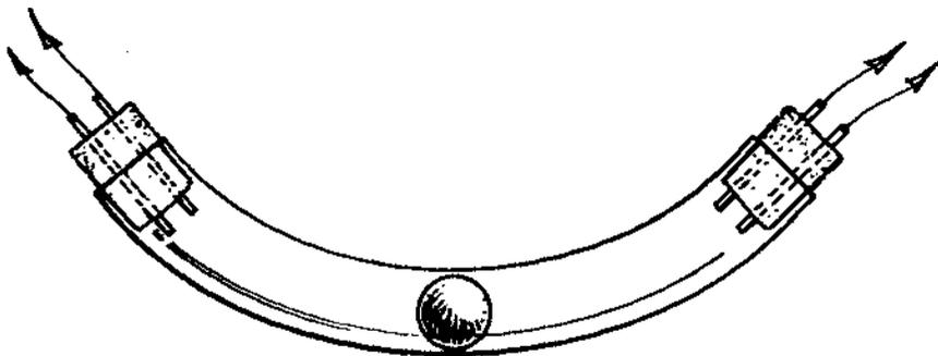
FIG. 43 BALL TUBE (DOUBLE)
