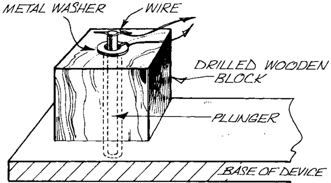
FIG. 39 A / LIFT BLOCK & PLUNGER
